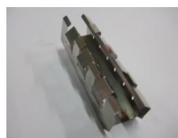
材料:ステンレス 304 バネ材 寸法:15mm × 50mm 板厚: t=0.1
