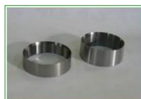
＜鉄(STKM)＞ 外径 45 x 厚さ 0.5 内径・外径精度 0.05 外径テーパ加工 内径ねじ加工
