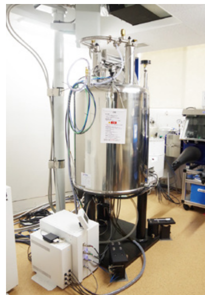
核磁気共鳴装置(NMR)
