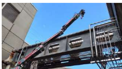
図1 自重補償機能搭載多関節アームロボット
