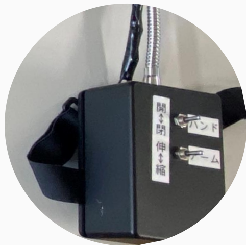
レバー操作によるアーム伸縮と ハンドの開閉操作自動化
