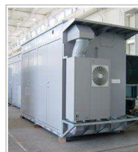
＜無線中継シェルター＞
