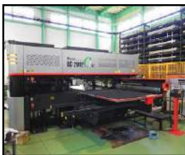
高度なパンチ・レーザー複合機でブランク加工
