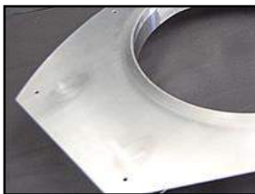
SUS304 1.5t 低歪みレーザー溶接水密カバー
