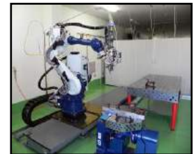
ディスクレーザー 5kw による高精度な精密溶接で低歪みな溶接加工
