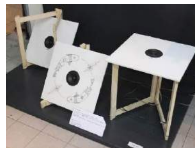
(LIMIX を共鳴板に使用したスピーカー試作品)
