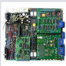
自動車生産工場 エンジンテストベンチ 制御用基板
