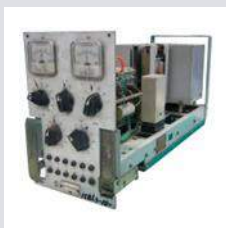
製鋼工場 サイリスタ制御用 UNIT
