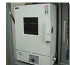
熱風循環式定温恒温機
