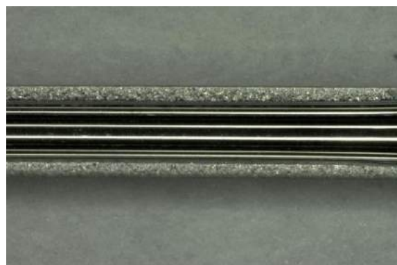
<パイプ内面研磨: 内径φ0.5mm、 表面粗さ: Ra0.02 μm>
