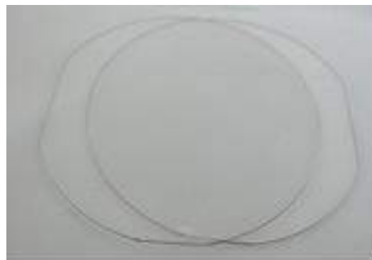
接合事例: SiO 2 の接合 原子拡散接合法(ADB)にて常温接合
