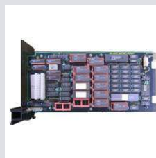
火力発電所 電算機 プロセス入出力盤
