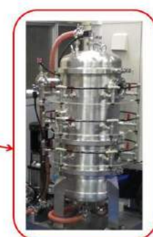
ろ過装置 (大型ろ過フィルターを 14本装着)
