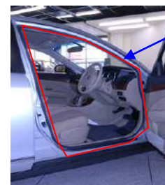
スリット隙間： 0.7～1mm 完成
