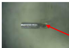
<外径 \phi 0.5 内径 \phi 0.2 SUS304>
