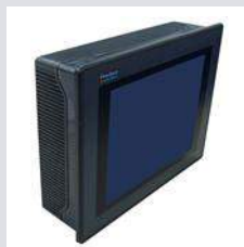
工場 生産監視システム タッチパネルコンピュータ
