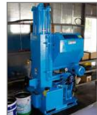
切屑は自動圧縮機で圧縮・固形化
