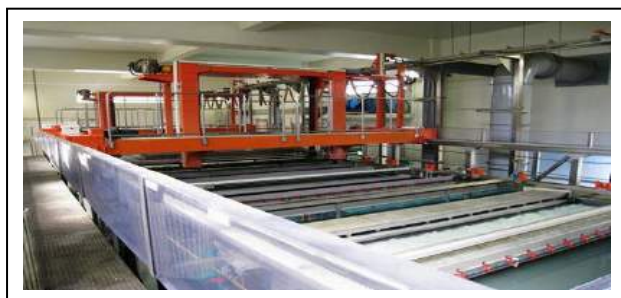
「全自動錫メッキライン」
