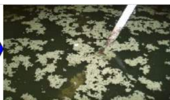
汚泥と上水を 分離した状態
