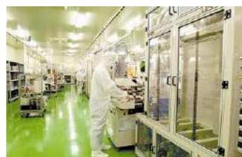
クリーンルームでのめっき工程
