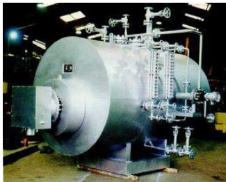
遊動管板式熱交換器
