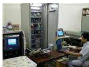
要求仕様に基づき、検査装置を使い制御装置の検査を行います。
