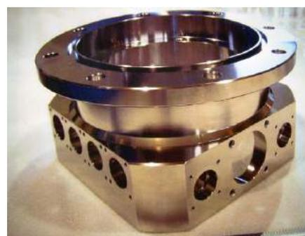
旋盤加工およびマシニングセンタ加工後、アルゴン溶接を行い、更に旋削で仕上げ加工したチャンバーの加工例です。
