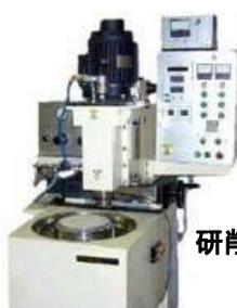
研削・研磨連続加工装置
