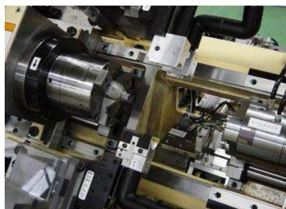
加工プログラムをパターン化、コレットチャック方式の採用によって、優れた精度を有し、加工精度も改善しました。
