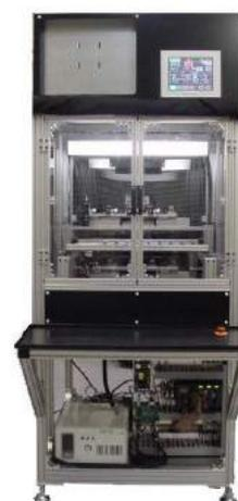
●**インテリジェント精密ネジ締めロボット HTDR3300**
