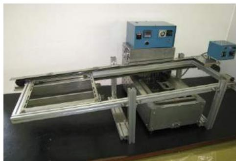
左のチタン製噴流式半田槽に搬送キャリアを取り付けた装置です。搬送部、キャリア、ノズルはオーダーメイドです。
