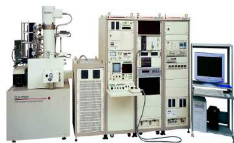
【世界で最も細い電子線が描ける描画装置】
