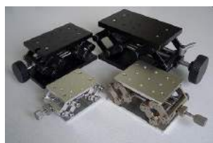
&lt;ラボジャッキ群&gt;
