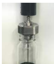
フィルター通液性 (アドバンテック製 TCF-005 (細孔径 0.05μm))
