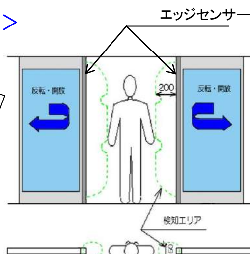
&lt; ドアエッジセンサー原理図 &gt;
