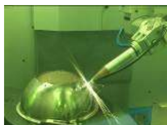
最新設備による斜め穴加工
