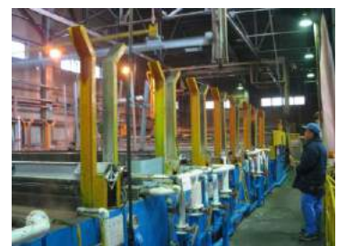
【工場内のカチオン電着塗装設備】
