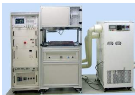
パワーモジュール動特性測定器 (加熱／冷却用チャンバー付き)
