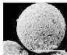
母粒子:樹脂 子粒子:酸化チタン
