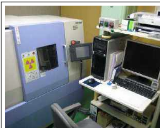
内部欠陥を検査するアルミダイカスト用 CT
