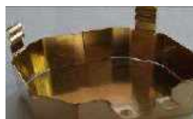
&lt;真鍮材 切削品から微細板金へ切り替え&gt;
