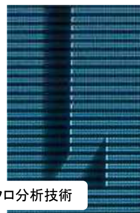
SiC 欠損部(櫛歯電極)
