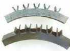
＜化学プラント用熱交換パイプへの 放熱フィン縫付溶接＞
