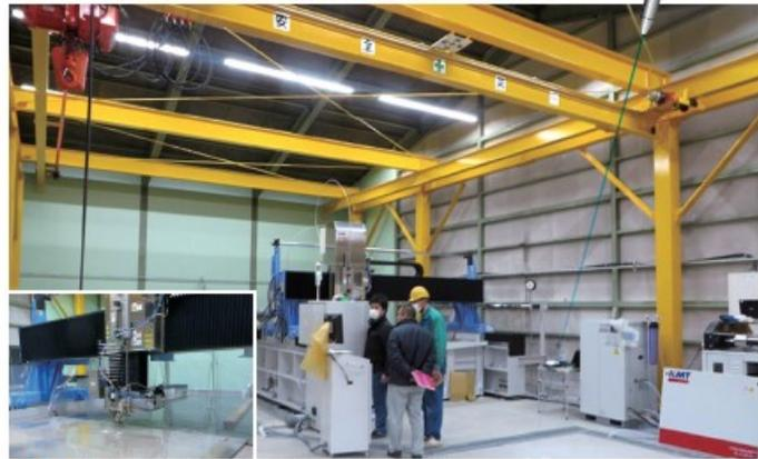
SWS 4643 最新技術を搭載、大型加工に最適です 加工範囲:2,450×4,300×300mm
