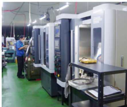
高精度な加工を支える歯車加工機
