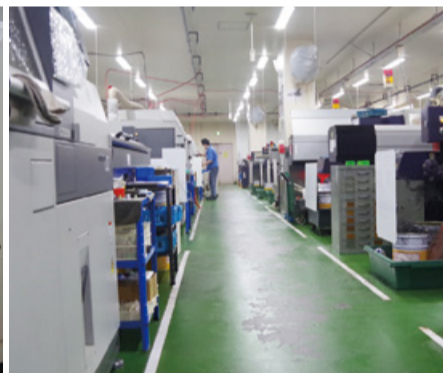
NC旋盤を約40台擁する
