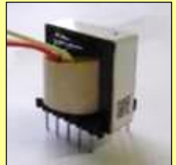
鉄道車両向けゲートドライバ用 高周波電源トランス
