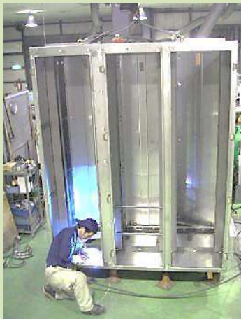
ステンレスの板で 製作した筐体
