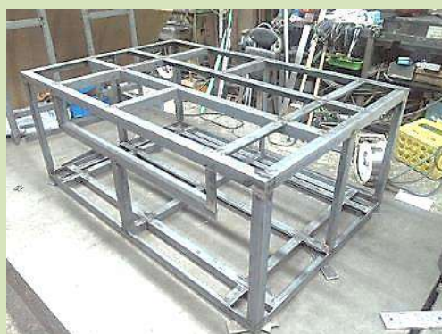
鉄のアングル、チャンネルで 製作したフレーム
