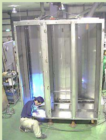
ステンレスの板で 製作した筐体
