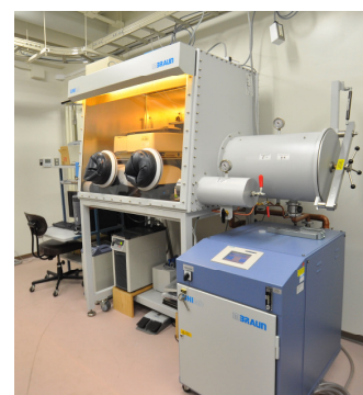
写真2: グローブボックス内での赤外吸収・電子吸収同時測定システム
