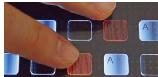
図 3. 透明電極を用いた電気触覚ディスプレイ
