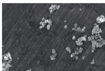
サブミクロンの汚染物 模擬粒子の生成
