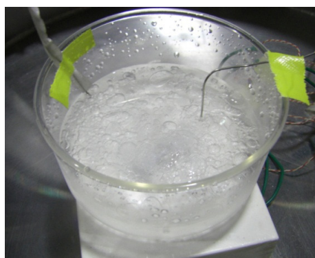
真空中での水溶液の沸騰を利用して氷を生成します
