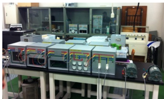
図2. モジュール型電力系統実習装置 「スッキリ！！」
