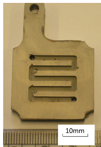
図1. 無電解めっきを施した燃料電池用部品
