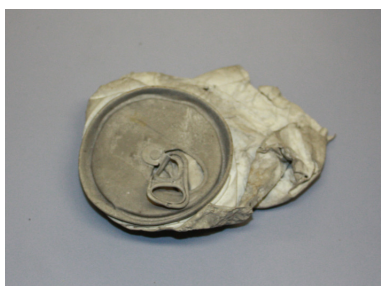
熱分解ガス化溶融プラントにおけるアルミ缶リサイクルの例
