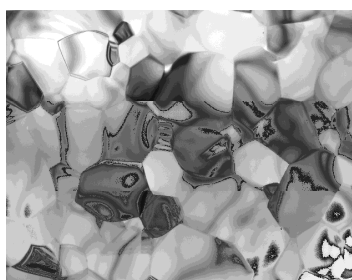
人工股関節用セラミックスの微構造 400kV 透過電子顕微鏡
