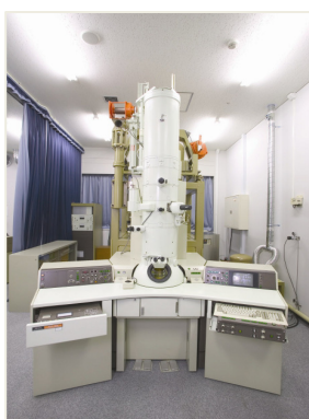
人工股関節用セラミックスの微構造 400kV 透過電子顕微鏡
