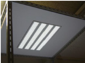
白色 LED 照明光源による不快グレア(まぶしさ)の実験
