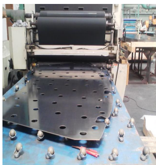
&lt; 鉄鋼板のバリ取り、研削後の様子 &gt;
