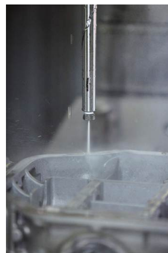
高圧狙い洗浄
