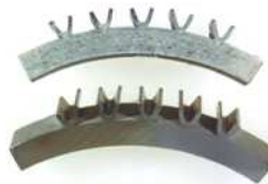
<化学プラント用熱交換パイプへの放熱フィン縫付溶接>
