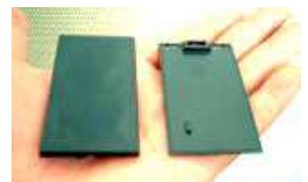
<携帯電話の電池> ・肉厚 0.3mm ・50ton クラス
