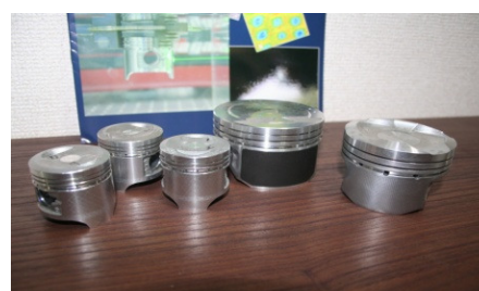
図4 ピストンの特殊レーザピーニング処理の例
