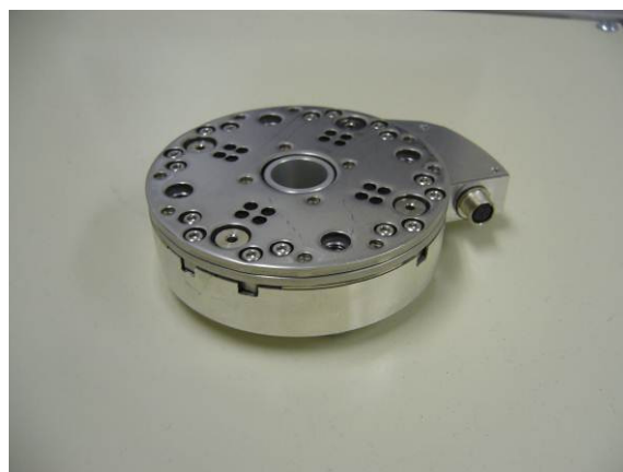
静電容量型6軸力覚センサ φ80×H22.4
